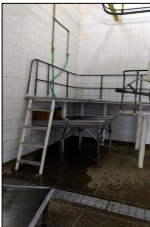
Figura 5: Área de sangria, com plataforma de esfolagem. Vista também da canaleta que encaminha os efluentes para a ETE.
