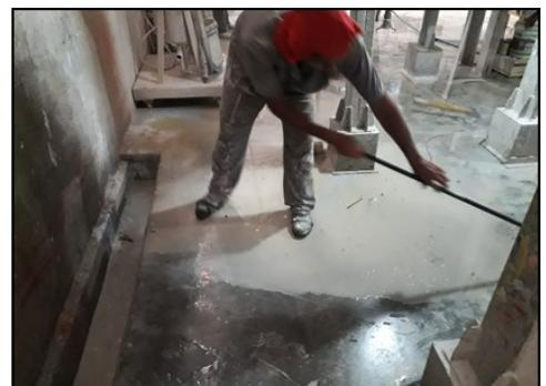
**Sequência 1** – Efluente após o tratamento é utilizado na limpeza do piso e direcionado para o ralo.
