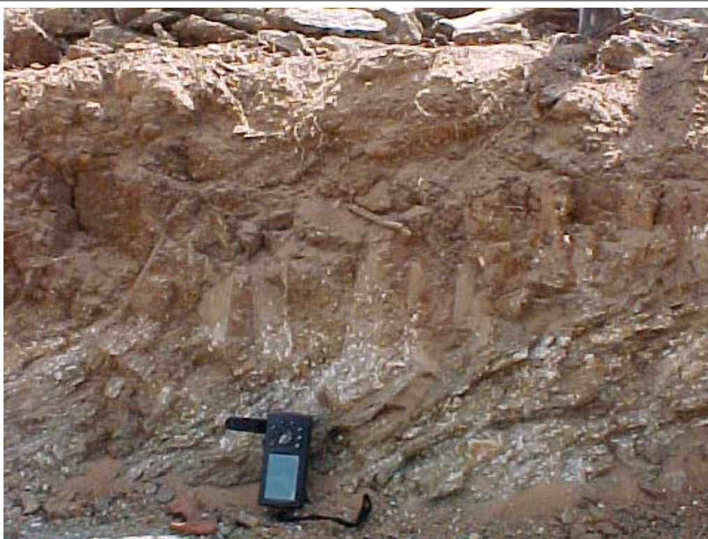
FOTO 10 – ESCAVAÇÃO ONDE OBSERVA-SE PERFIL DE SOLO MOSTRANDO ESPESSURA BASTANTE DELGADA
