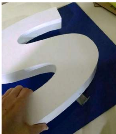
Figura 30 - Letra caixa encaixada nas cantoneiras L 1x1/16
