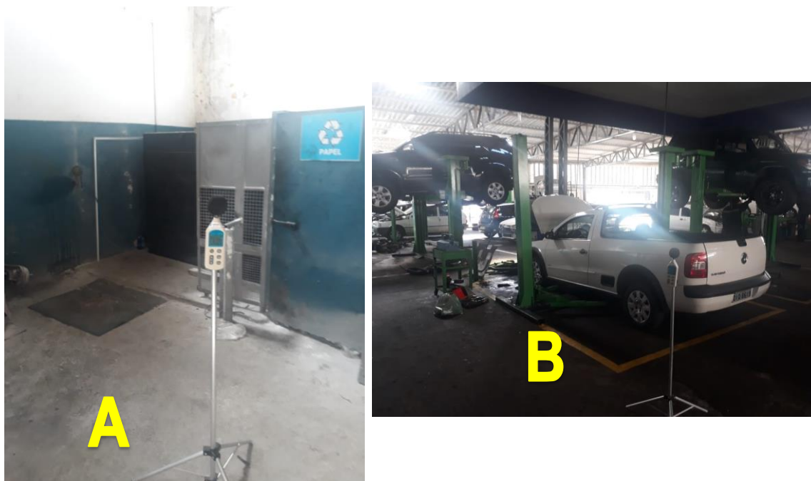
Figura 03 – Instalação do decibelmetro dentro do estabelecimento. (A) Compressor enclausurado; (B) local de geração de ruídos diversas
