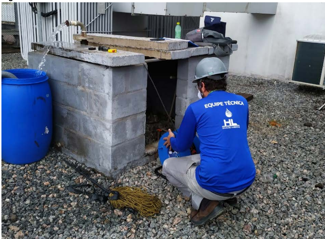
Figura 5 - Teste de vazão em reservatório de 100 litros.
