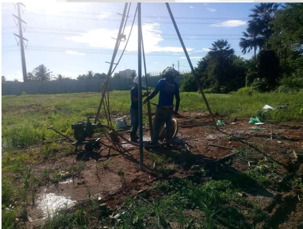
Foto 03 - Detalhe da operação do Ensaio a Percussão para determinação do SPT.
