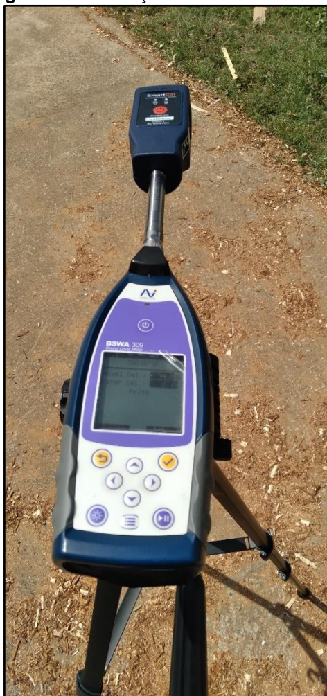
Figura 2 – Calibração do sonômetro in loco .
