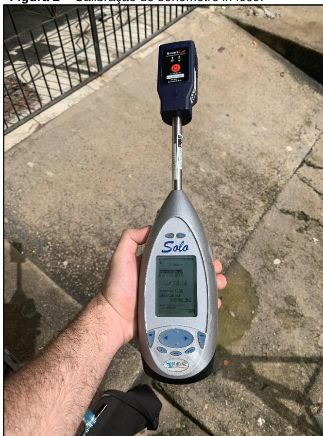
Figura 2 – Calibração do sonômetro in loco .
