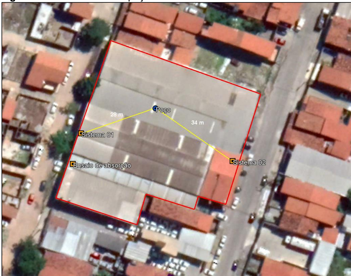
Figura 2 – Distância entre o poço aos sistemas de fossa e sumidouro
