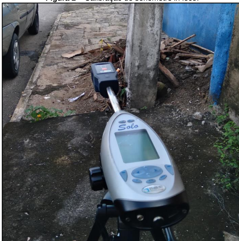
Figura 2 – Calibração do sonômetro in loco .
