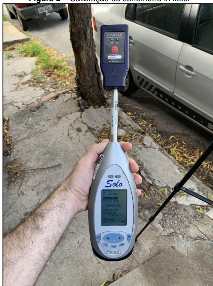
Figura 2 – Calibração do sonômetro in loco .
