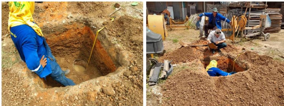
Figura 02 – Escavação da vala e ensaio CAS no terreno.
