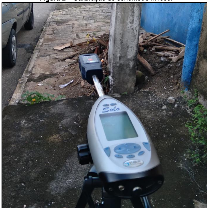
Figura 2 – Calibração do sonômetro in loco .
