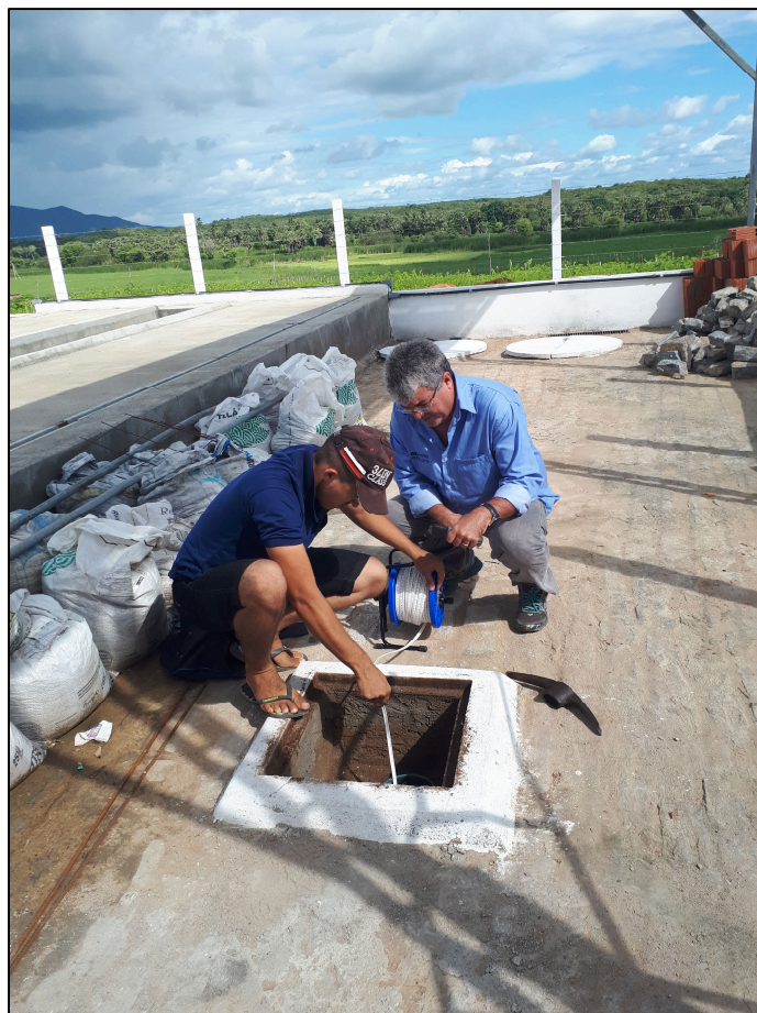
Foto 03 – Execução do Teste de Bombeamento - Medição do NE e ND
