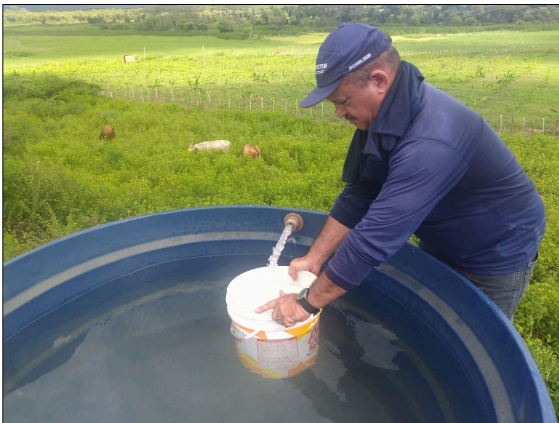
Foto 04 – Execução do Teste de Bombeamento - Medição da Vazão
