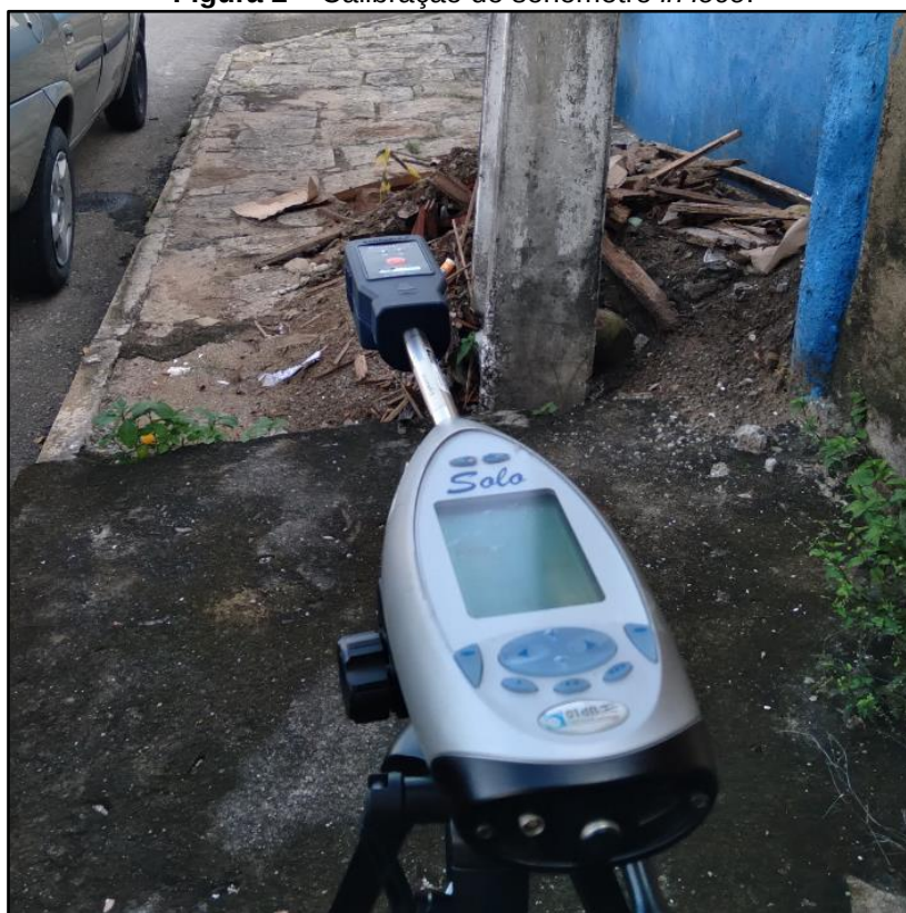
Figura 2 – Calibração do sonômetro in loco .
