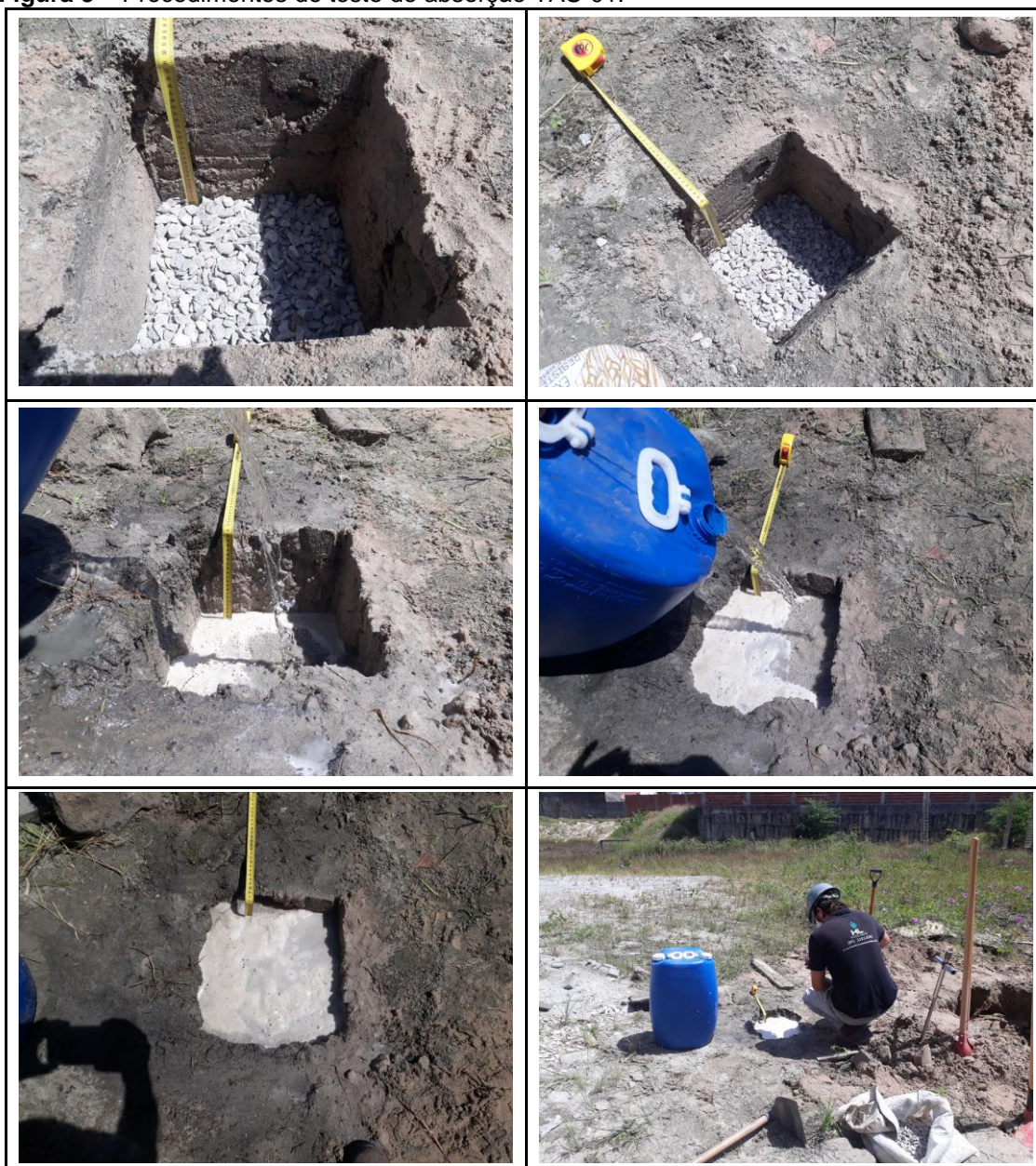
Figura 3 – Procedimentos do teste de absorção TAS-01.
