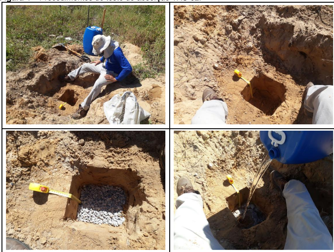
Figura 4 – Procedimentos do teste de absorção TAS-02.
