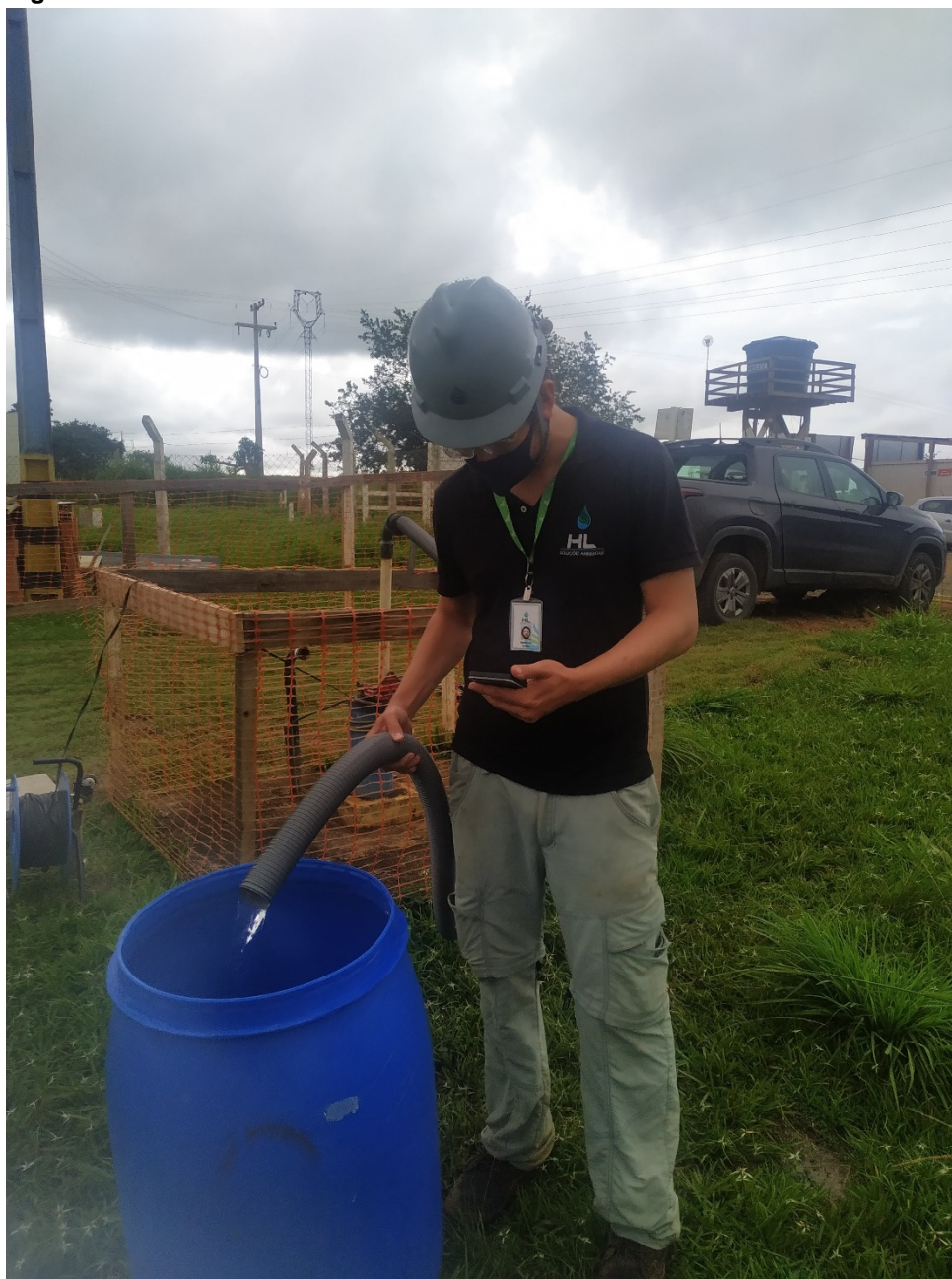
Figura 4 - Teste de vazão utilizando reservatório de 100 litros..
