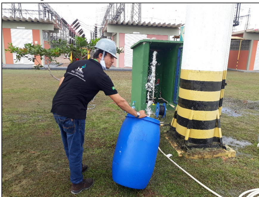
Figura 4 - Teste de vazão em reservatório de 100 litros.
