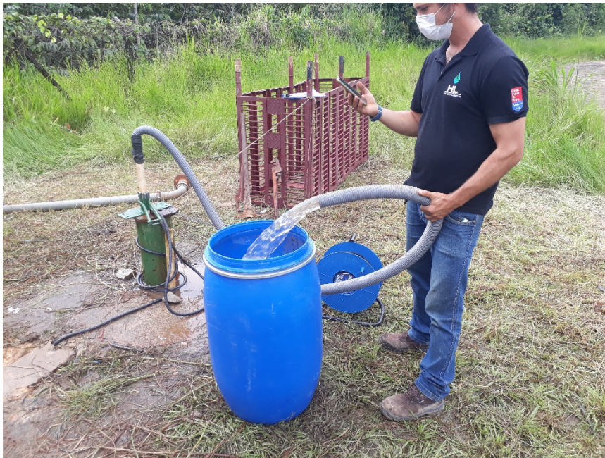
Figura 4 - Teste de vazão em reservatório de 100 litros.
