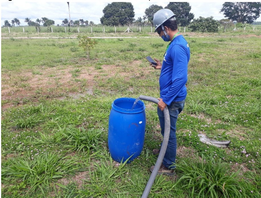
Figura 4 - Reservatório de 100 litros usado para o teste de vazão.
