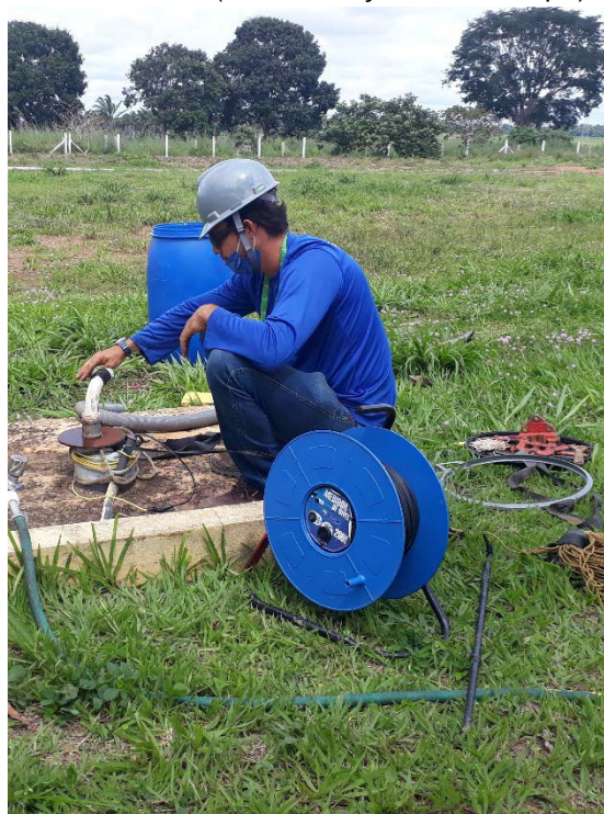
Figura 3 - Medição do nível d'água através do medidor de nível ( Em ilustração e em campo)
