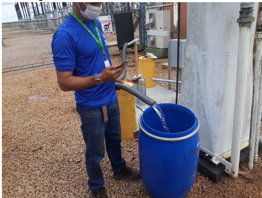
Figura 4 - Teste de vazão em reservatório de 100 litros.
