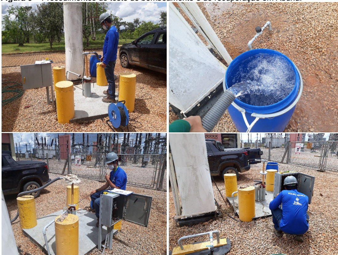
Figura 5 – Procedimentos do teste de bombeamento e de recuperação em Abunã.
