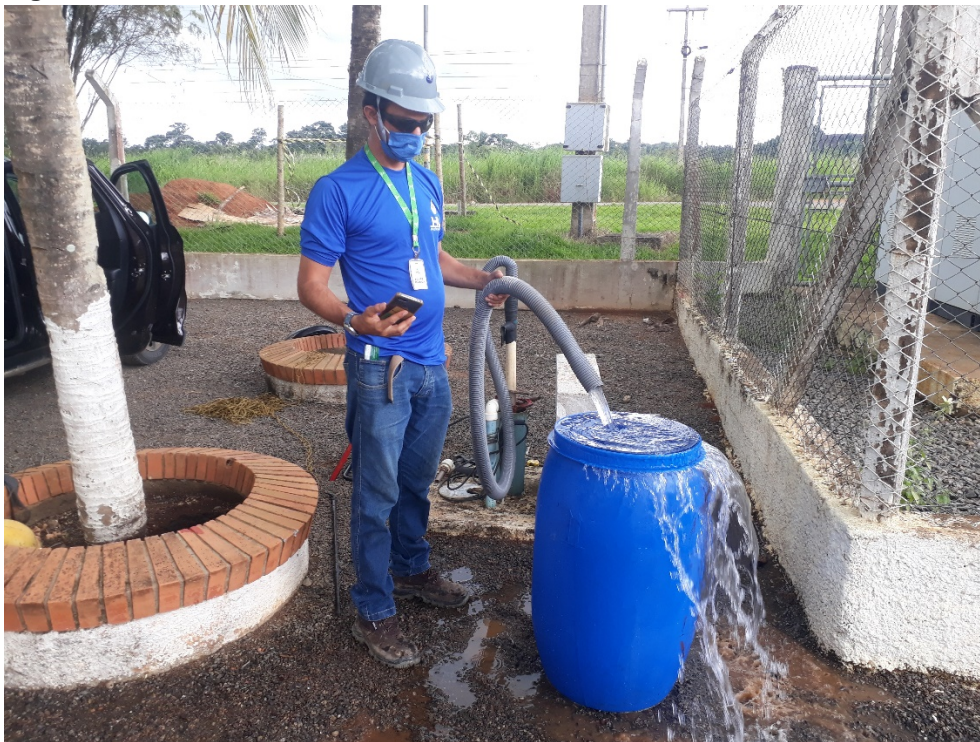
Figura 4 - Teste de vazão em reservatório de 100 litros.
