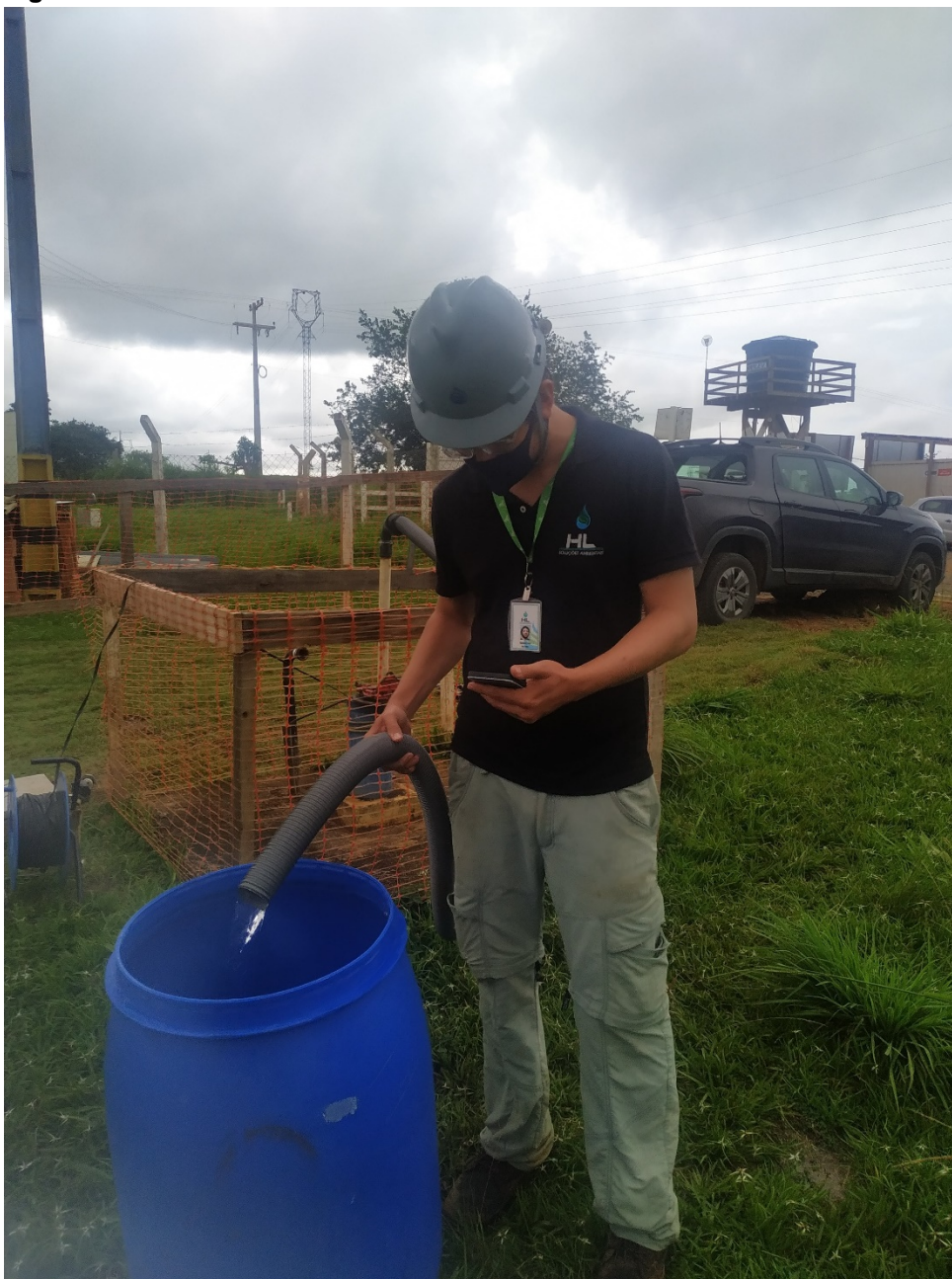
Figura 4 - Teste de vazão utilizando reservatório de 100 litros..
