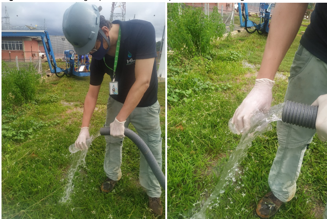
Figura 6 - Coleta de água para análise físico química e microbiológica.
