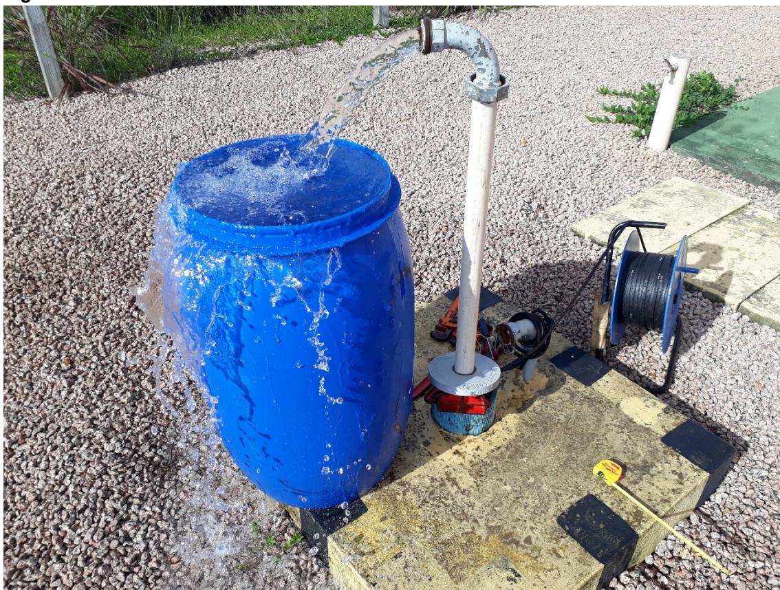
Figura 5 - Teste de vazão em reservatório de 100 litros.
