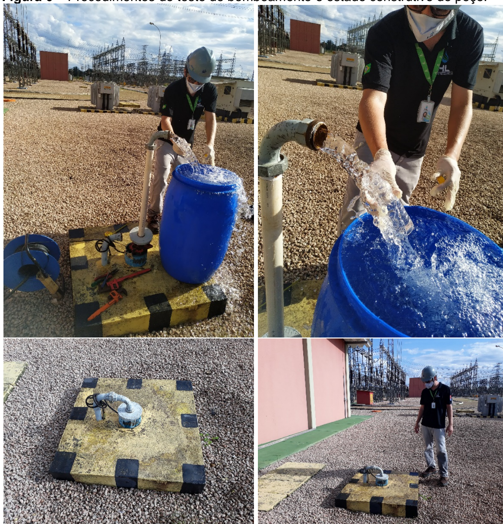
Figura 6 – Procedimentos do teste de bombeamento e estado construtivo do poço.
