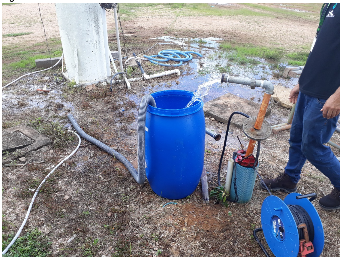
Figura 5 - Teste de vazão em reservatório de 100 litros.
